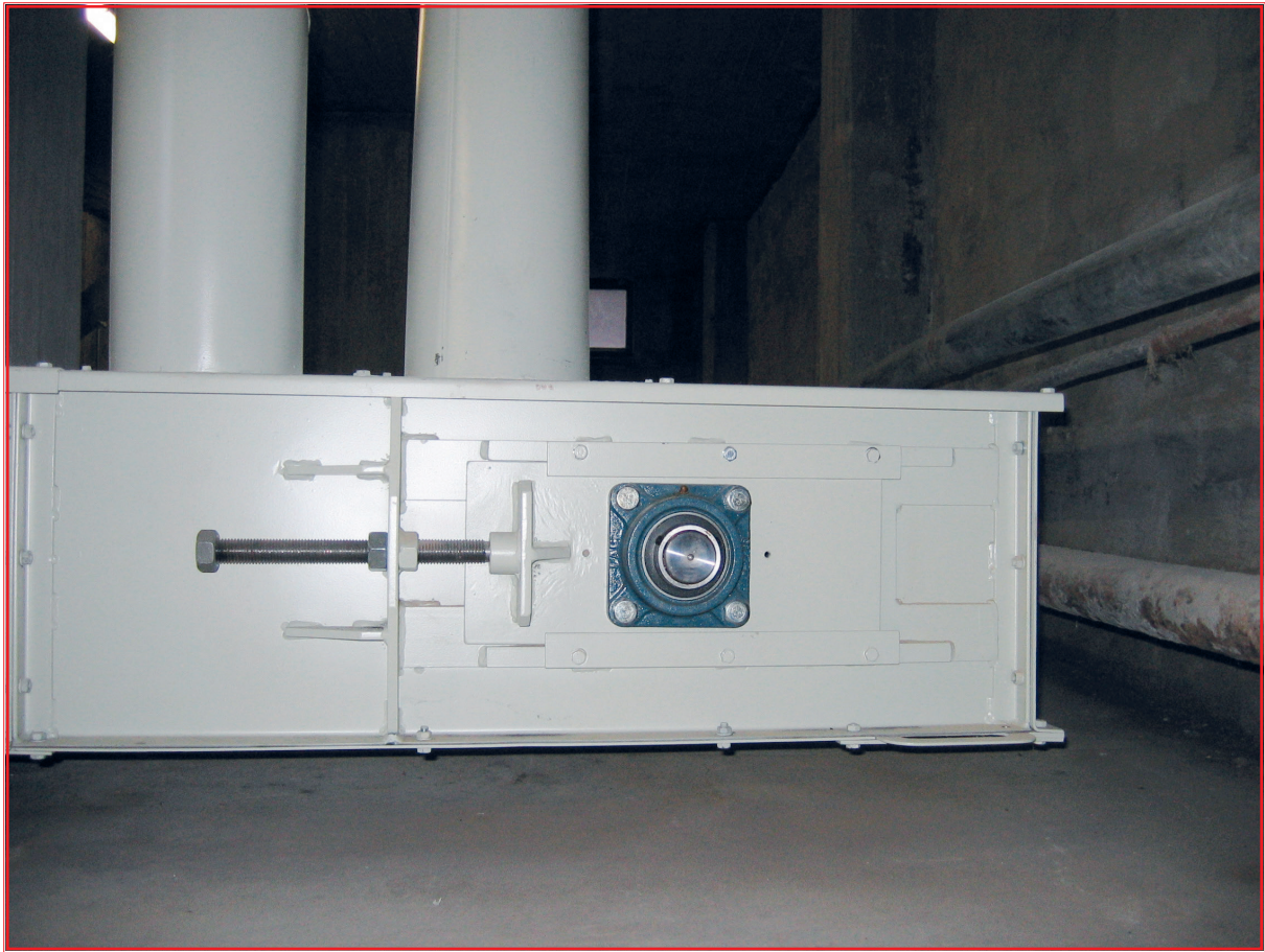
Kuva 4. Taittopään kotelo, säätölevy, säätöruuvi ja laippalaakeri.
