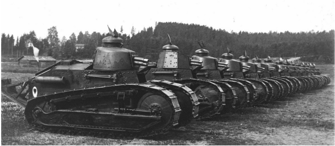
Yhden patteriston / hyökkäysvaunukomppanian tankit rivissä. Edessä on 37 mm Puteaux tykillä ja niiden jäljessä 8 mm Hotchkiss konekiväärillä aseistettuja Renault FT17 hyökkäysvaunuja.
