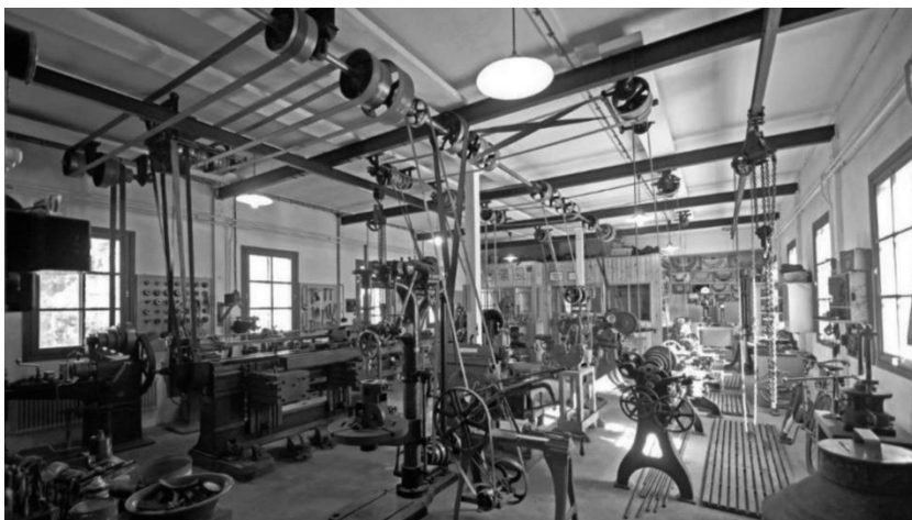
Valta-akseli antoi hihnojen välityksellä voimaa koneille ennen sähkömoottoreiden yleistymistä. Kuva Nivalassa sijaitsevan Museokonepaja Toimivan sivulta Konepajamuseo.fi.
