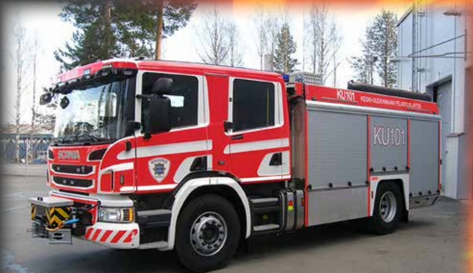
Keski-Uusimaan Saurus FSC28/COBRA -pelastusauto KU101. Sen alustana on Scania P370 4x2. Autossa on Esteri D-240 -keskipumppu ja 2 800 litran vesisäiliö. Varustuksiin kuuluu mm. sähköinen 5,4 tonnin vinssi ja CCS Cobra -sammutusleikkuri.
