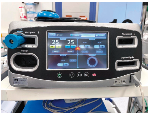
Kuva 1.15b. Sähkökirurginen generaattori leikkaussalissa. Kuvan generaattoriin voidaan yhdistää sekä monopolaarista bipolaari-instrumenttiä bipolaaritekniikkaa hyödyntävä kudossulkuinstrumentti.
