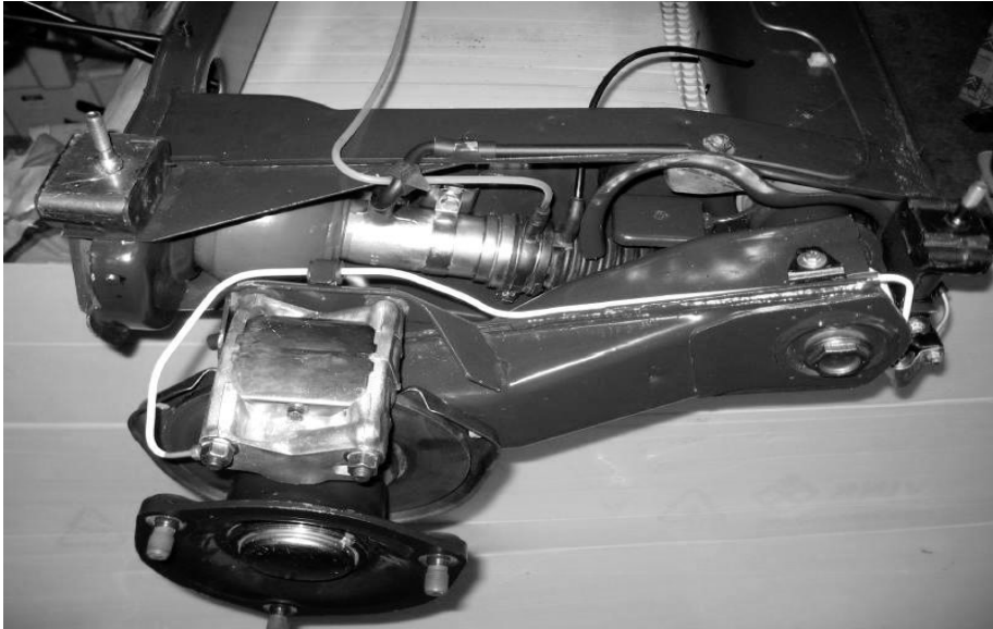
Takakelkan hydetekniikkaa näkyvillä jousitus ja jarrut. Alakuvassa etupään vaimentimien rakennetta. GS on hieno valinta harrasteautoksi.
