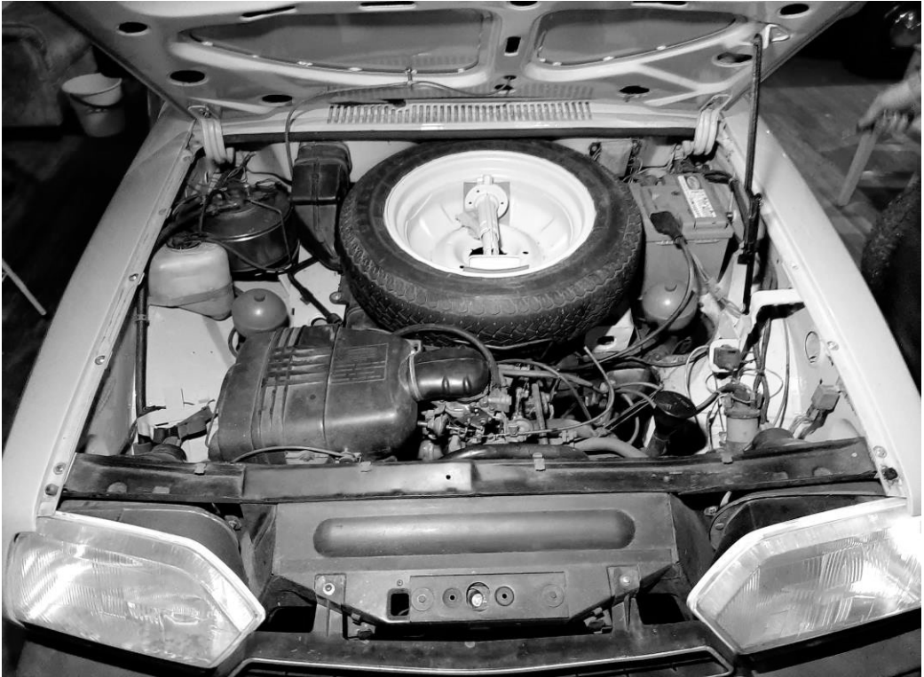
Kuva moottoritilasta; Citroen GSA Artsi Sevesusi tuotanto. Renkaiden vaihdossa käytettävä omalaatuinen ja toimiva tunkki varapyörän syvennyksessä. Bokserimoottorin purputusta on kiva kuunnella peräpäästä ja moottorin jyminää keulassa.
